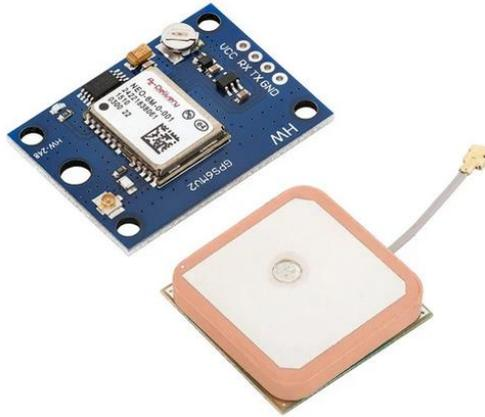
Ilustración 8. Sensor GPS NEO-6M. Fuente: [9]
