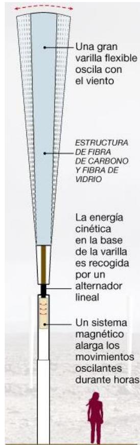
Fig. 4.2. Partes del aerogenerador Vortex [110]
