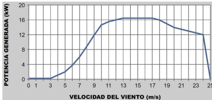
Fig. 2.5. Curva de potencia del aerogenerador [02]
