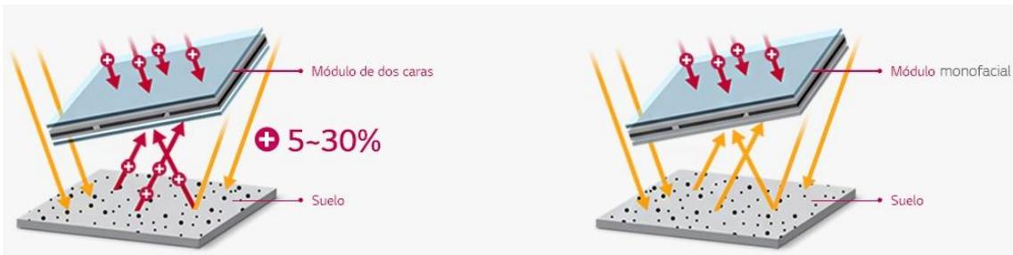
Fig. 7.11. Módulo bifacial y módulo monofacial [97]
