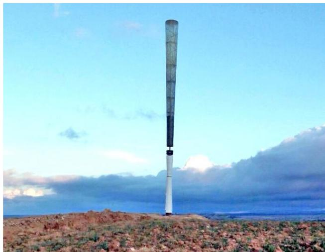
Fig. 4.1. Aerogenerador Vortex sin palas [109]
