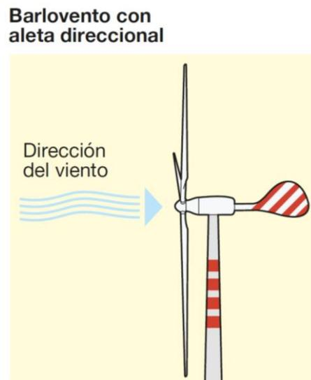
Fig.14.29. Aerogenerador de eje horizontal a barlovento con aleta direccional [30]
