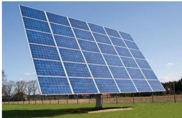
Fig. 9.5. Seguidor solar de dos ejes [106]
