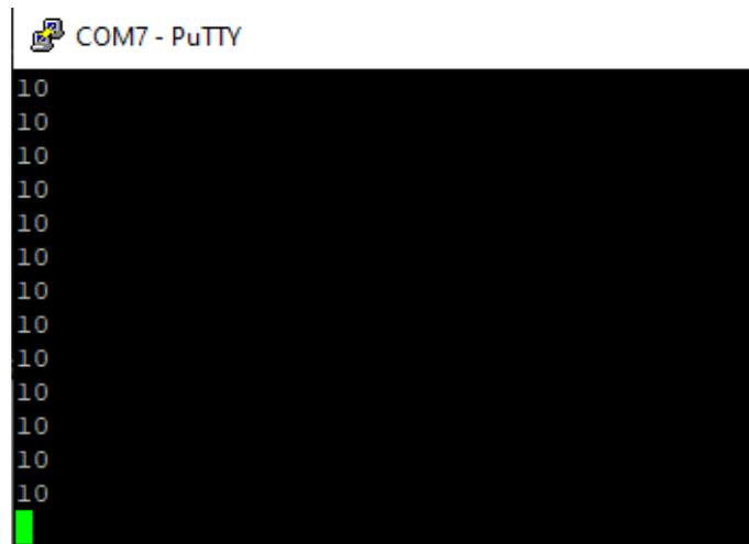
Figura 58. Valores de distancia, leídos por el puerto serie, para un objeto ubicado a 10 cm.
