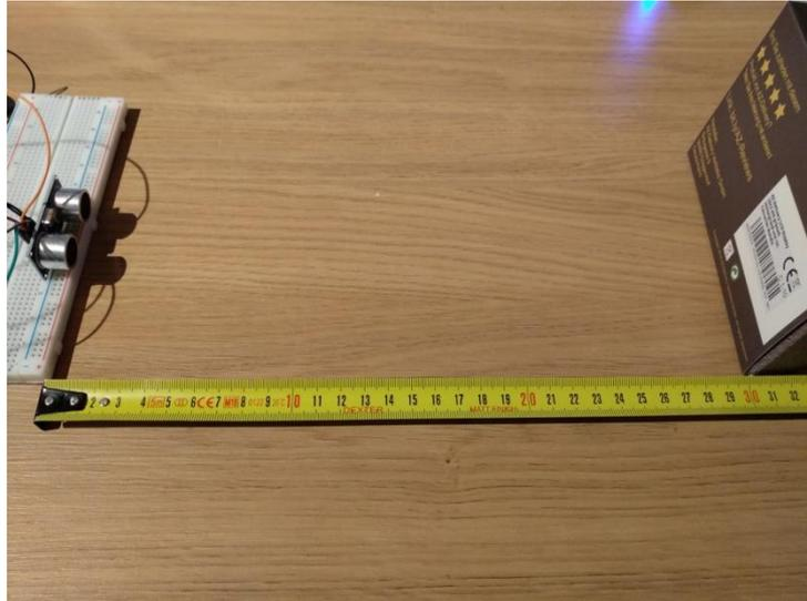
Figura 59. Sensor ultrasónico HC-SR04 con objeto a 30 cm.
