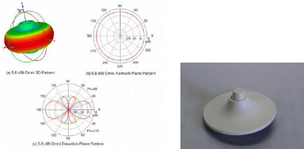
Il·lustració 24: Diagrama radiació antena omni (esquerra) i antena omni indoor (dreta)
