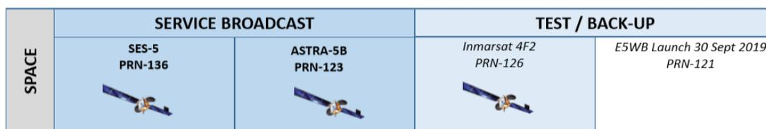
Ilustración 4. Configuración del segmento espacial [Ref.13]
