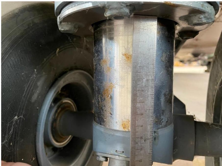
FIGURA 35 - MEDIDA DEL STROKE DEL NLG
