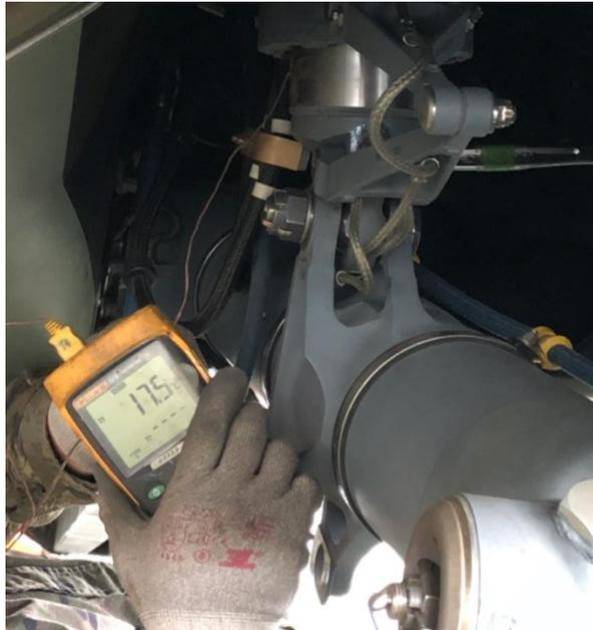
FIGURA 6 - MEDIDA DE TEMPERATURA DEL STROKE
