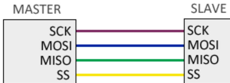
FIGURA 14 - CONEXIONADO DEL BUS SPI
