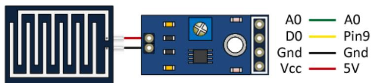
**Figura 17: Conexión YL-83 con Arduino UNO [50]**
