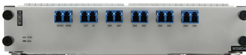
Ilustración 48 filtro WSMD4. [22]Fuente Huawei
