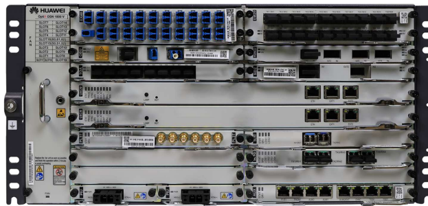
Ilustración 43 Ejemplo de OSN1800V – Alimentación en continua. [22]Fuente Huawei
