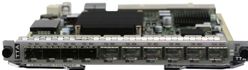
Ilustración 51 Tarjeta de tributario TTA. [22]Fuente Huawei
