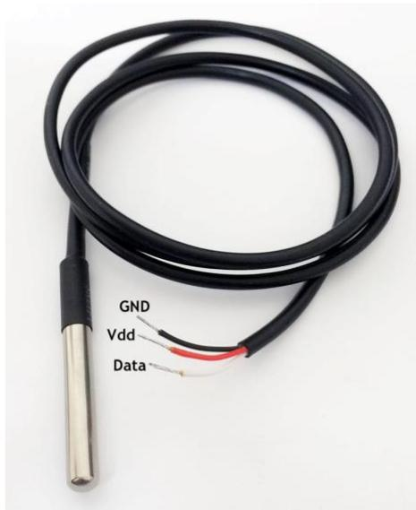
**Ilustración 18: Sensor de temperatura DS18B20**
