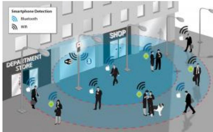
**Ilustración 3: Aplicación BLE - Localización indoor [6]**
