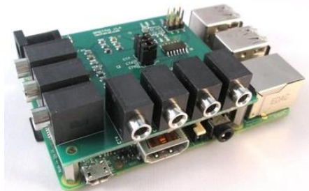
Figura 42. Raspberry Pi con el Hat Lechacal RPICT7V1 que puede medir hasta 7 líneas eléctricas.
