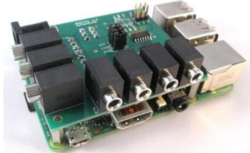
Figura 31. Ejemplo del HAT instalado en la RPi [Re xxxxiii ] http://lechacal.com/wiki/index.php?title=RPiCT7V1_Version_5
