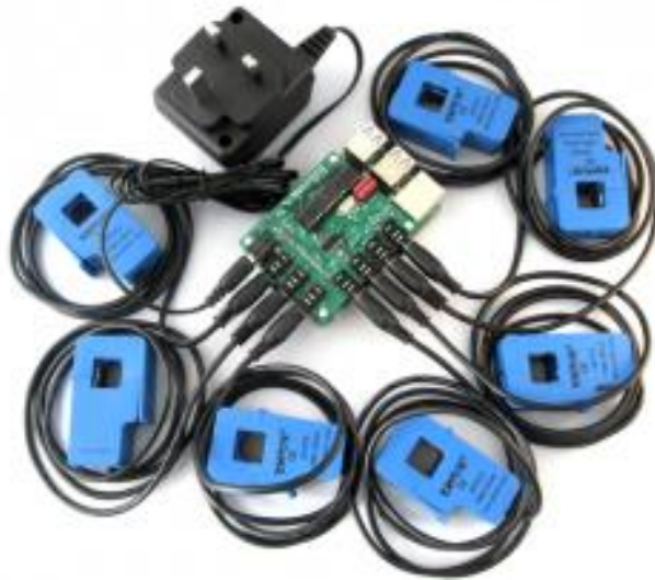
Figura 37. Ejemplo de Raspberry Pi con Hat RPICT7V1 y 7 transformadores SCT-013-000 conectados
