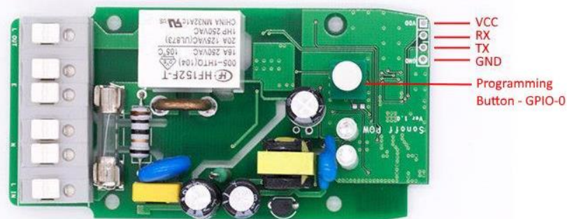
Figura 45. Conexiones serie del Sonoff POW
