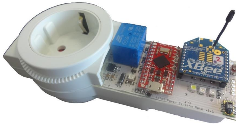
Figura 68. Arduino con una pinza CT
