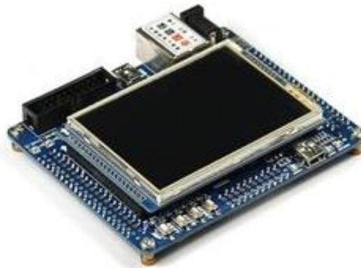
Ilustración 10. LPC1768 Mini-DK2, procesador de la serie NXP LPC17XX (núcleo Cortex-M3).
