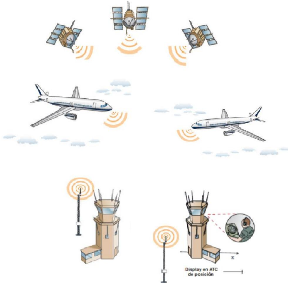
Ilustración 6. Ejemplo de tráfico aéreo con tecnología ADS-B
