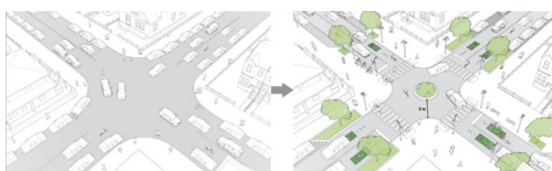
[136] Esquema de pacificació del trànsit en un encreuament.
