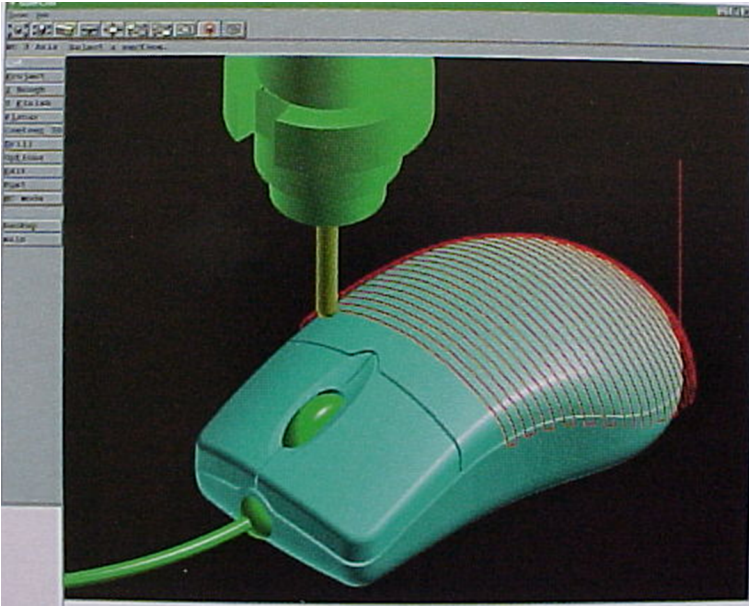
Figura 7. Simulación de las trayectorias de la herramienta en la mecanización de una superficie compleja
