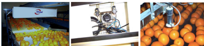
Sistema de visió artificial mitjançant càmeres capaces de classificar la fruita en una cinta transportadora segons la seva forma o mida, i determinar el grau de maduració per mitjà del color. Font: Giró (2005)
