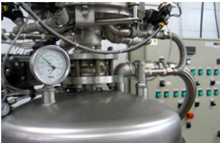
Instal·lació de descompressió instantània controlada
