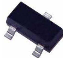
Figura 7: Sensor de temperatura MCP9700
