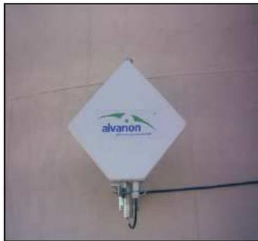
Sistema Alvarion BreezeNet B100 con antena de 21 dB integrada en el propio equipo.
