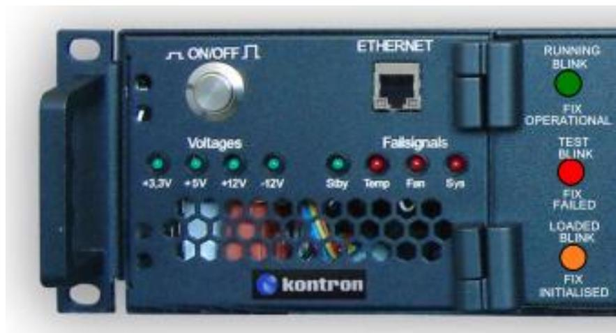
Figura 10 - LEDs de estado del Nuevo chasis (derecha)
