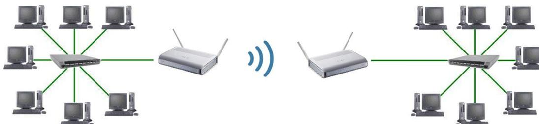
Con esta configuración una LAN no inalámbrica se beneficia de la tecnología inalámbrica para realizar interconexiones con otras redes, que de otra forma serían más costosas, o simplemente imposibles si las condiciones del terreno no son apropiadas.
