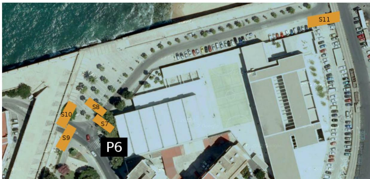
\*Los sensores S9 y S10 se encargan del control de entrada/salida de la zona violeta a la zona verde. El sensor S7 controla la entrada a la zona roja y los sensores S8 y S11 controlan la salida de ésta.
