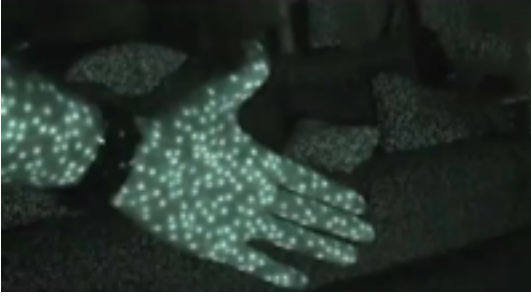
Fotografia infraroja en què es mostra el núvol de punts infrarojos que emet la Kinect per a obtenir la profunditat de la imatge. Font: www.mattcutts.com
