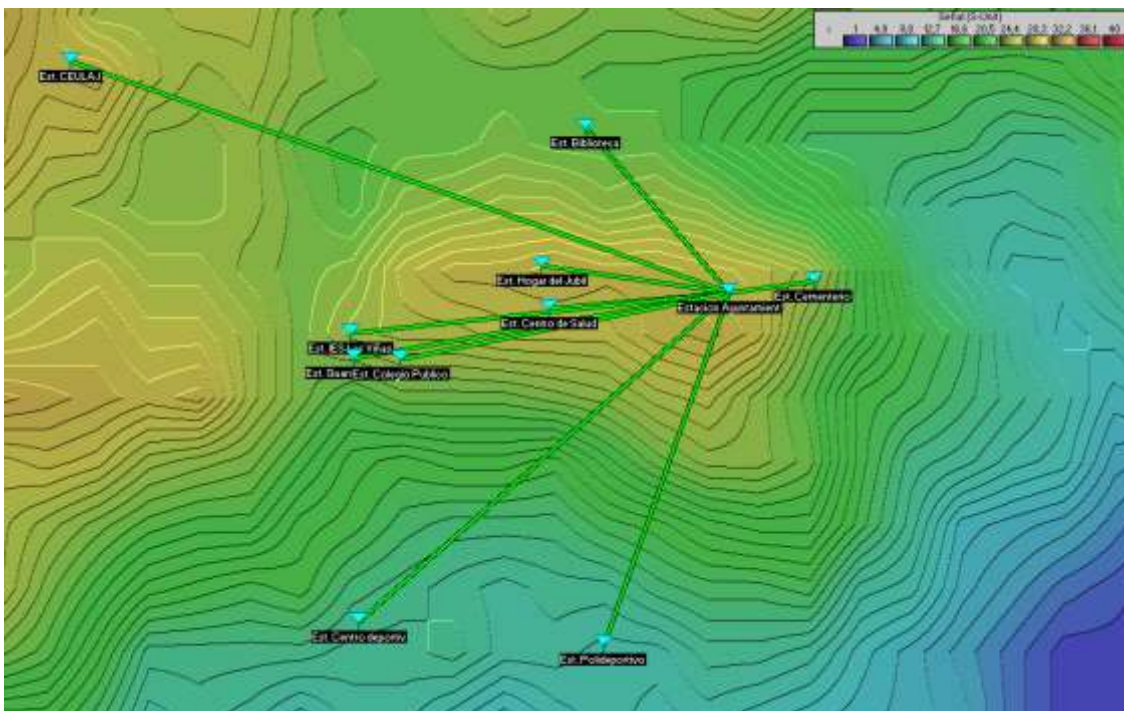
Ilustración 18: Esquema red troncal Wimax en la simulación con Radio Mobile.
