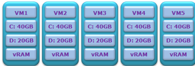
Figura 33.- Almacenamiento y RAM para las VMs
