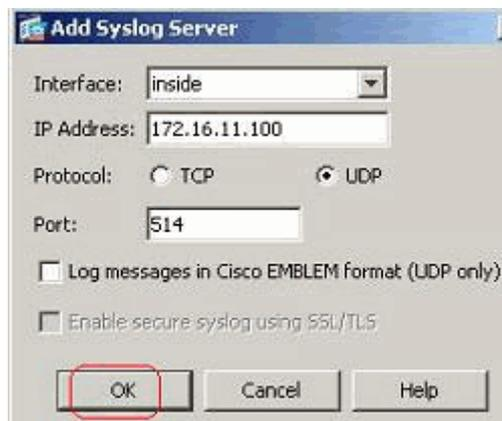
Ilustración 47. Configuración Routers CISCO (3).
