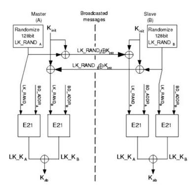
3. Una vez que los dispositivos emparejados disponen de la clave de enlace Kab, ésta, se utiliza para autenticarse automáticamente en las sucesivas conexiones.
