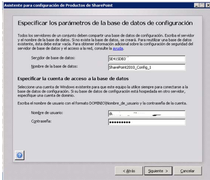
Figura 22. Especificar los parámetros de la base de datos de configuración.
