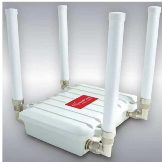
Así meshlium es un magnífica solución que permite integrar en un solo dispositivo la coordinación de los diferentes detectores ZigBee instalados, el almacenaje de las lecturas realizadas por los Wasmote y el envío de esta información mediante Wifi a otro nodo para su posterior tratamiento.
