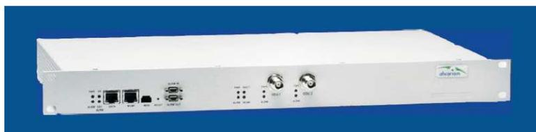
**Ilustración 24.** Micro Base Station Indoor Unit
