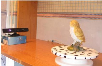
Preparación de escaneado del mussol con Skanect
