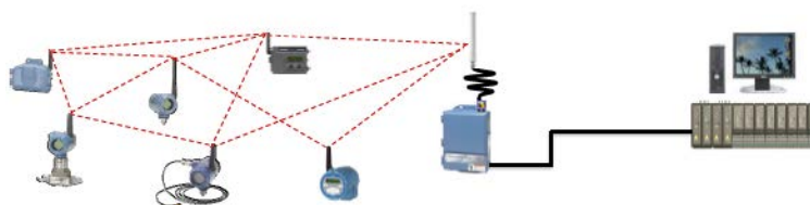
Figura 20: Conexión cableada del Gateway a la red de control
