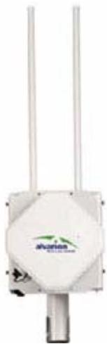
Los Alvarion BreezeMAX Wi2 ofrecen una doble solución incluyendo en un mismo equipo un punto de acceso Wifi 802.11b/g en banda de 2,4 GHz, y por otro lado la capacidad Wimax del BreezeMAX CPE expuesto anteriormente para proveer la conectividad al backhaul. De este modo, la misma estación suscriptoras que se conecte a la estación base BreezeMAX Extreme 5000 del monte de A Carballeira, proveerá a su vez de un punto de acceso Wifi a los usuarios de la red para que hagan uso de este servicio
