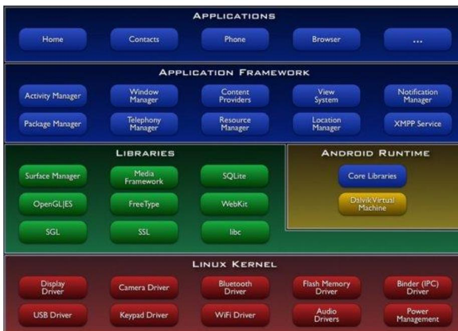
4. Pila de Software del SO Android
