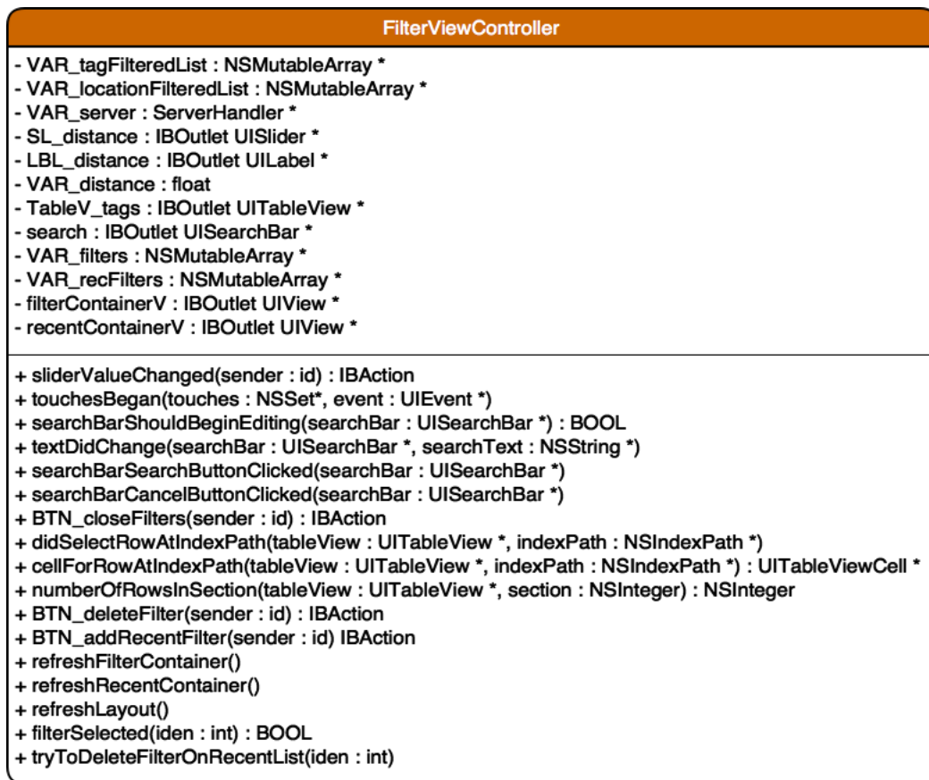
Figura 5.11: Controlador del panell de filtres
