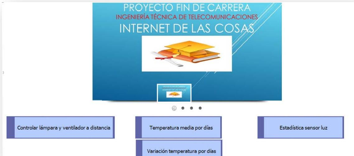
Si pulsamos en el botón “**controlar lámpara y ventilador a distancia**”, accedemos al servidor web instalado en nuestro Arduino, y desde donde seremos capaces de controlar dos leds independientes que simulan una lámpara y un ventilador.
