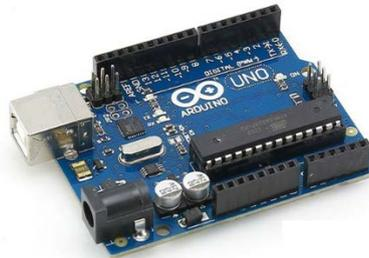
Es el componente principal del prototipo. Consta de una placa electrónica basada en el microprocesador Atmega328.
