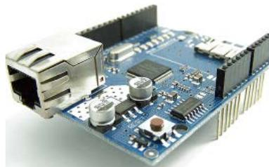
Basado en el chip de ethernet Wiznet W5100 cuenta con funcionalidades de IP tanto para TCP como UDP, posee un conector RJ45 estándar para ethernet y soporta hasta 4 conexiones simultáneas, incluye un slot para tarjetas micro-SD.
