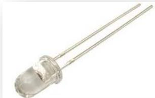
Es un componente optoelectrónico pasivo y, más concretamente, un diodo que emite luz. La pata más larga es el ánodo positivo y la más corta es el cátodo negativo.
