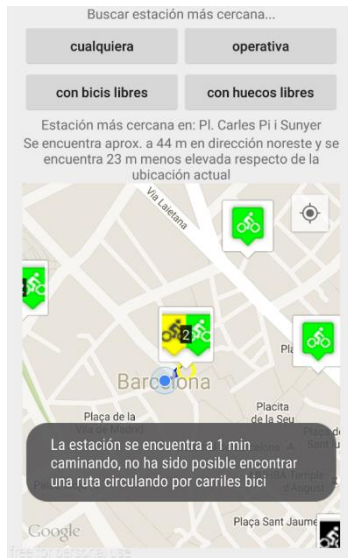
Figura 29.- Después de pulsar el botón 'cualquiera' la vista se centra en la estación más cercana (sin condiciones) y se muestra Toast con detalle.
