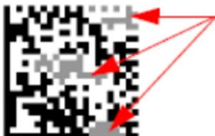
Un buen resultado consistiría en que todos los elementos oscuros tengan el mismo nivel de reflexión, un mal resultado, como el mostrado en la imagen, consiste en diferentes niveles de reflexión.
