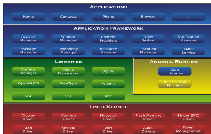
Figura 4.1: Arquitectura Android. Fuente: https://es.wikipedia.org/wiki/Android .
