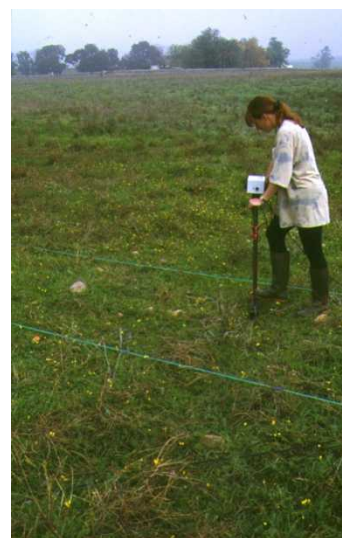
Prospector con la estructura de madera que incluye dos electrodos remotos y un resistómetro.
