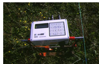
Resistómetro Geoscan RM14 que incorpora su propio ordenador.
