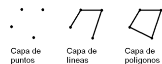
Diferentes estructuras de datos en el formato vectorial.
