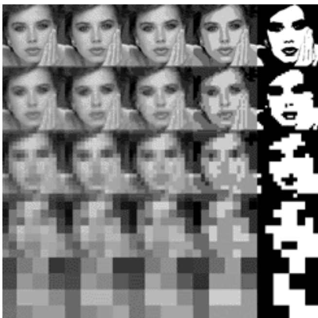
Variacions de la definició espacial i la resolució tonal d'una imatge digital a partir de la mera reducció de les variables de pixel·lació i profunditat de color en l'arxiu gràfic original
