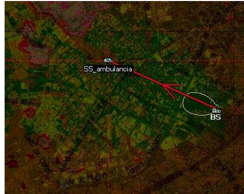
Figura 21. Dispositivo SS_ambulancia en zona de sombra.
