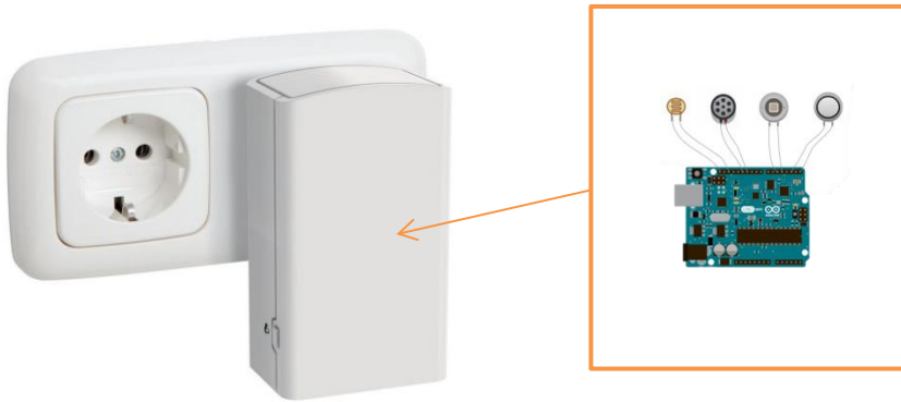
Figura 17: Prototip Hi-Fi dispositiu Arduino
