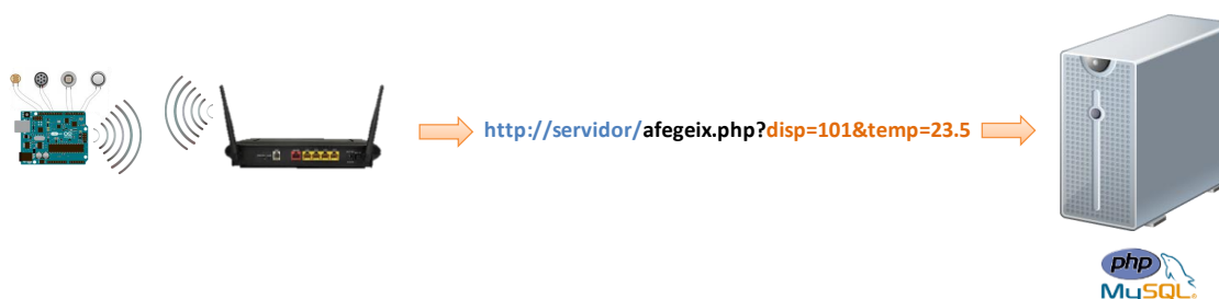
Figura 3: Enviament de dades des d' Arduino cap al servidor
