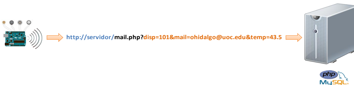
Figura 5: Crida des d' Arduino cap al servidor per enviar mail d'alerta
