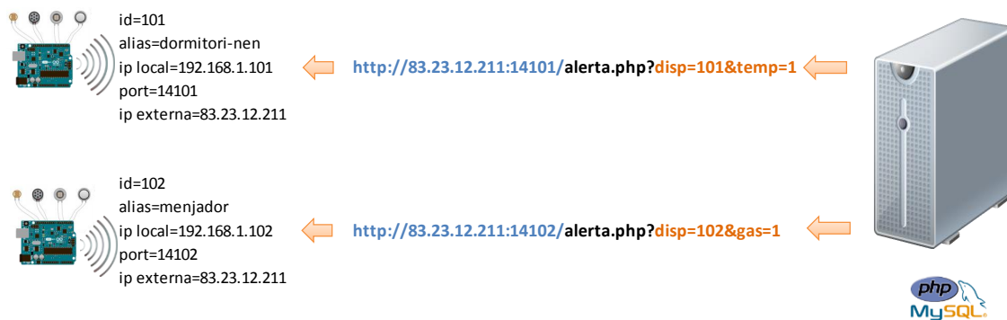
Figura 4: Recepció a Arduino dels paràmetres de config. de les alertes
