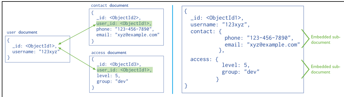
Figura 18 A la izquierda relación mediante referencia, a la derecha mediante documentos incrustados [39]
