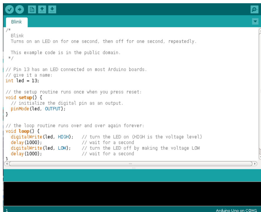
Figura 38 IDE de desarrollo de Arduino, código para apagar y encender un LED
