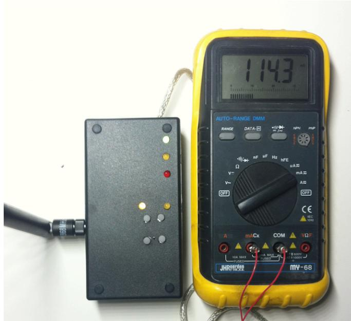
**Figura 25.** Test-setup para la medida del consumo
