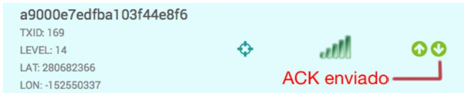
Figura 23. Transmisión con ACK. El backend responde enviando un ACK al prototipo.
