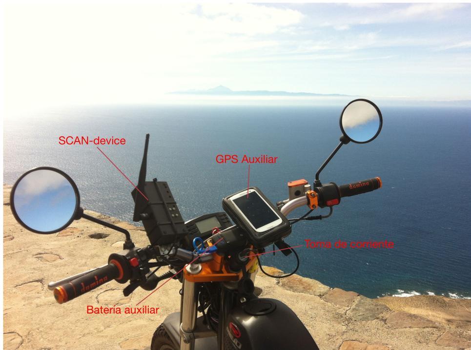
**Figura 40.** Configuración del panel de medida instalado en la motocicleta
