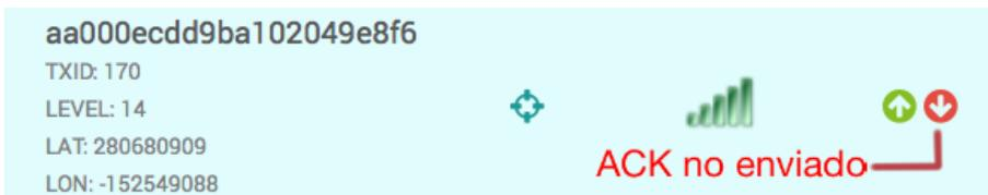
Figura 24. Transmisión con ACK. Se fuerza un error en el backend para que no envíe el ACK hacia el prototipo.
