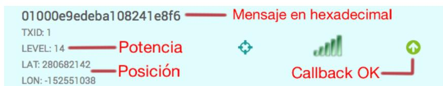
**Figura 20.** Mensaje a 14 dBm recibido correctamente en el backend.
