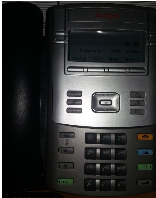
Figura 16: Avaya 1120 instal·lat amb Elastix
