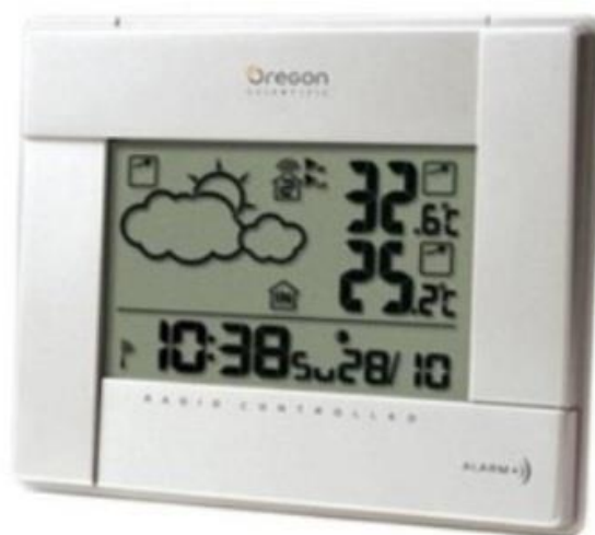
Figura 18: Estación meteorológica con sincronización horaria
