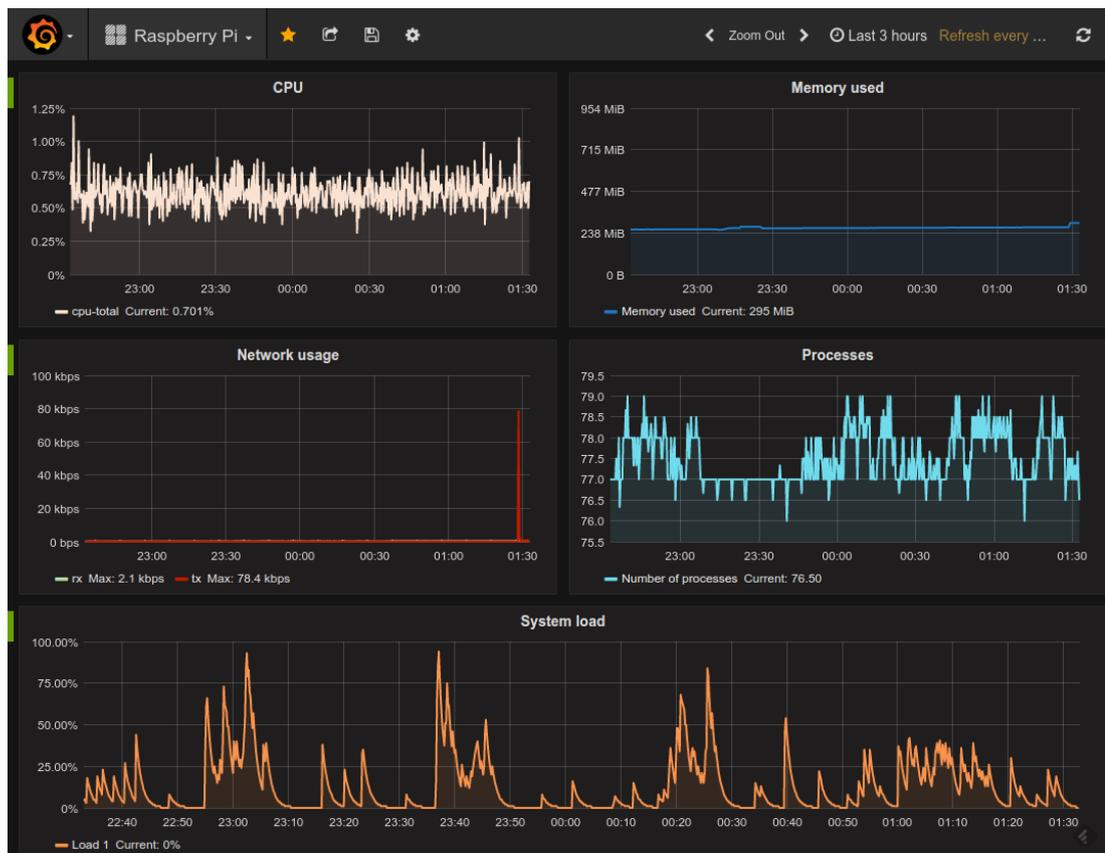
Figura 3.10: Panel de control de Grafana para monitorizar Raspberry Pi
