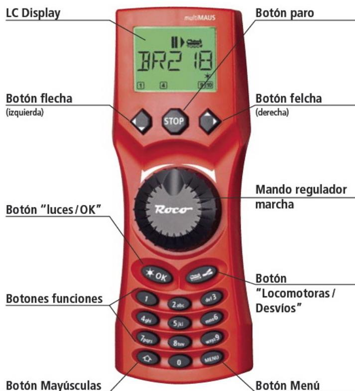
Con este mando de control digital se pueden controlar tanto las locomotoras (en todas sus funciones) como los desvíos y señalizaciones. La multimaus envía sus órdenes en paquetes digitales a las vías. Locomotoras y desvíos "escuchan" por así decirlo mediante sus propios decodificadores. Cada componente reaccionará sólo cuando la señal de control le afecte, no interfiriendo en el funcionamiento de otros dispositivos que formen parte del sistema digital.
