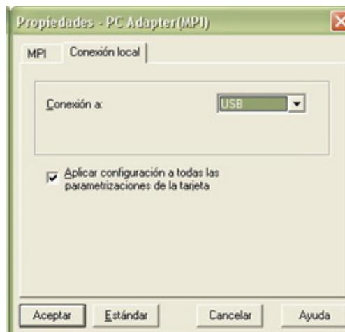
En esta ventana se ha seleccionado el tipo de conexión existente, en este caso, el adaptador MPI lleva conexión USB, por lo tanto, se selecciona “Conexión a” USB. Se marca la casilla “Aplicar configuración a todas las parametrizaciones de la tarjeta”.
