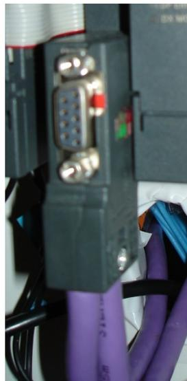
En los dispositivos que sean fin de la red PROFIBUS (S7 226 Estación 2 por un extremo y el PC por el otro extremo) y, por tanto, sólo tendrán utilizado el canal de entrada del conector, hay que ajustar la resistencia terminadora en posición on. Esto indica que ese dispositivo es el último de la red, y por lo tanto, no hay canal de salida conectado por el que seguir transmitiendo información.
