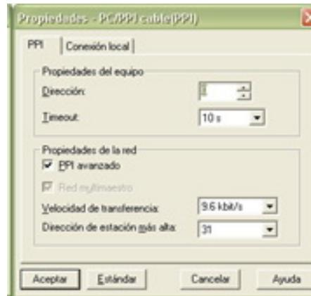
La dirección de la estación es 0, puesto que además la CPU S7 226 que es conectada, será la única estación conectada al bus PPI, con un timeout de comunicación establecido en 10 segundos.
