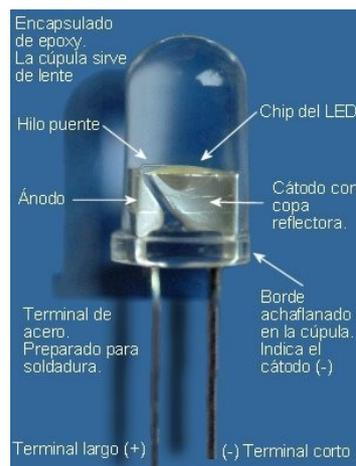
En el diseño realizado del circuito de semáforo, el terminal corto (cátodo) va conectado a masa, es decir, al borne central del terminal de conexión, mientras que el terminal largo (ánodo) va conectado a la salida digital del autómata (+24V DC).
