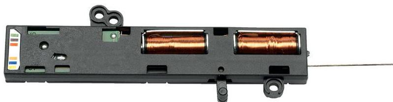
La función del cambio eléctrico ordenado por el decodificador hará que la varilla de la parte delantera del dispositivo se mueva. Esta varilla pasará por un paso especial del interior de la vía, y su movimiento producirá el cambio de aguja de vía visto desde la parte exterior de la misma.
