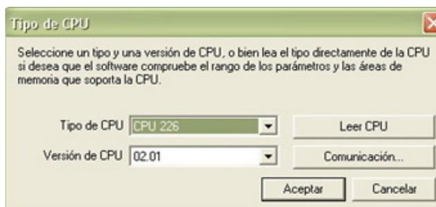
Si ya se ha configurado anteriormente la comunicación correcta alguna vez que el programa hubiese estado abierto, directamente seleccionar la CPU correcta y la versión de firmware de la misma. Si es la primera vez que se va a realizar la configuración de comunicaciones, se tienen dos opciones:
