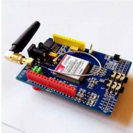
**Ilustración 24. Tarjeta GPRS Shield SIM 900**
