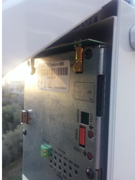
Ilustración 53 Conexión SIM (3G)
