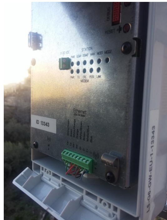
Ilustración 52 Conexión de alimentación por POE
