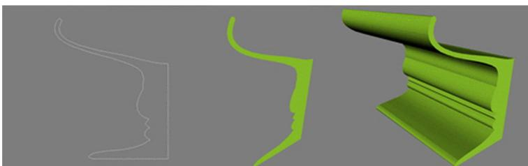
**Lathe.** Funciona por rotación de 360° sobre su eje, de un dibujo plano hecho con *splines*, que representa el perfil del objeto. Se utiliza, por ejemplo, para modelar una copa o un jarrón o cualquier otro objeto, cuya forma se defina por el desarrollo circular y uniforme de su perfil.
