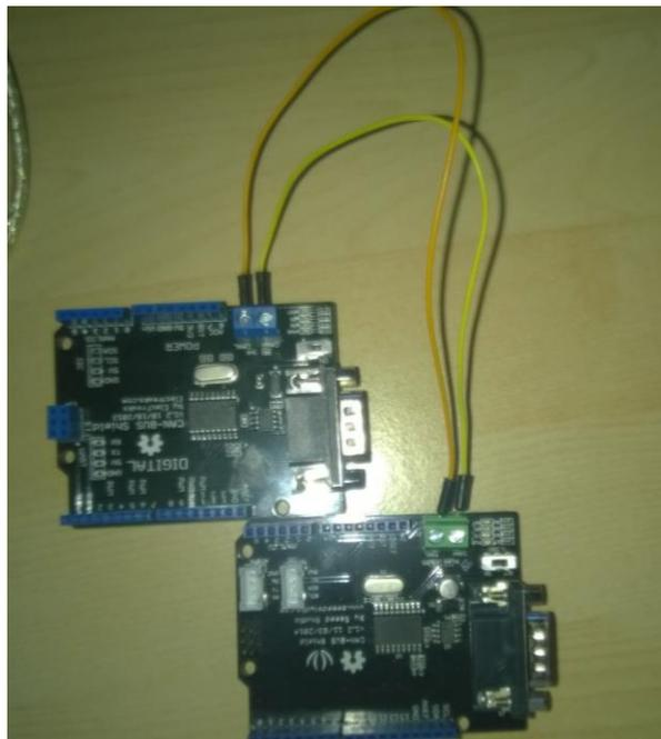
*Ilustración 69: Conexión entre nodo esclavo y nodo master. Fuente propia.*
