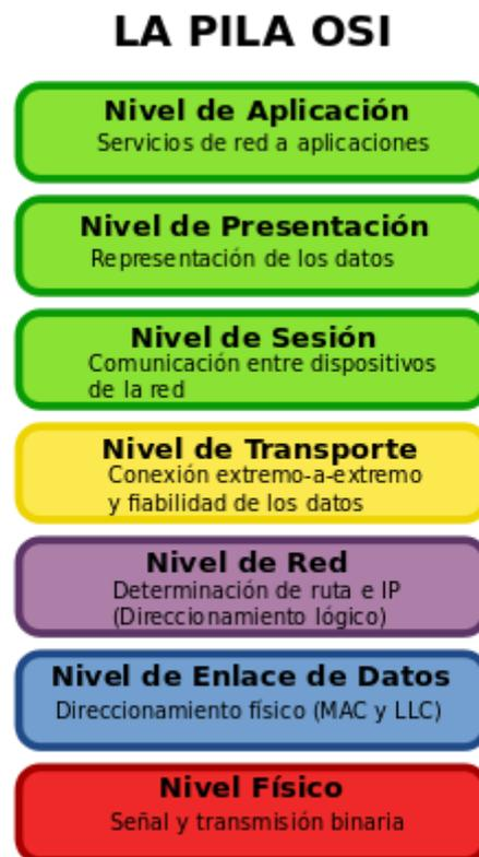
*Ilustración 30: Capas del modelo OSI. Obtenido de [39]*
