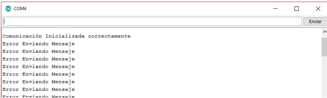
*Ilustración 56: Monitorización de puerto serie de la comunicación CAN Bus del nodo esclavo. Fuente Propia*
