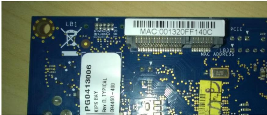
*Ilustración 59: Localización de la dirección MAC de una Intel Galileo. Fuente Propia*
